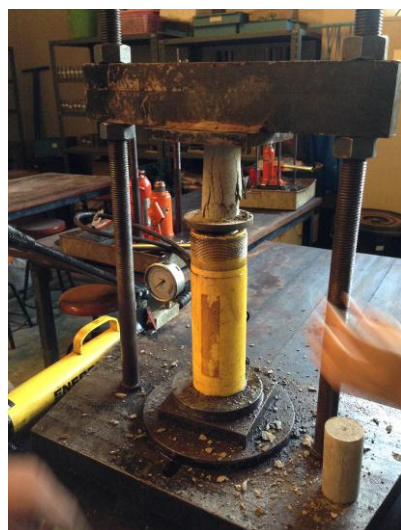
รูปที่ 3.3 การทดสอบกำลังอัดในแกนเดียวของก้อนตัวอย่างดินตะกอนประปาจิโพลิเมอร์
